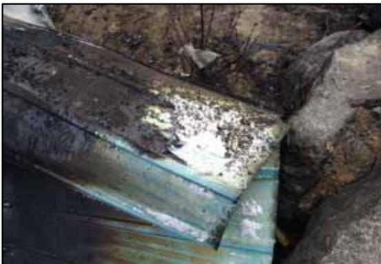
[사진7] 벽체 및 칸막이용 스티로폼 샌드위치 패널 및 자재 창고내 유사제품
